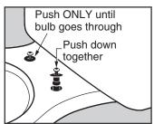
NOTE: FLANGE MUST REMAIN ABOVE THE SURFACE. DO NOT ALLOW PLUG TO FALL THROUGH!
